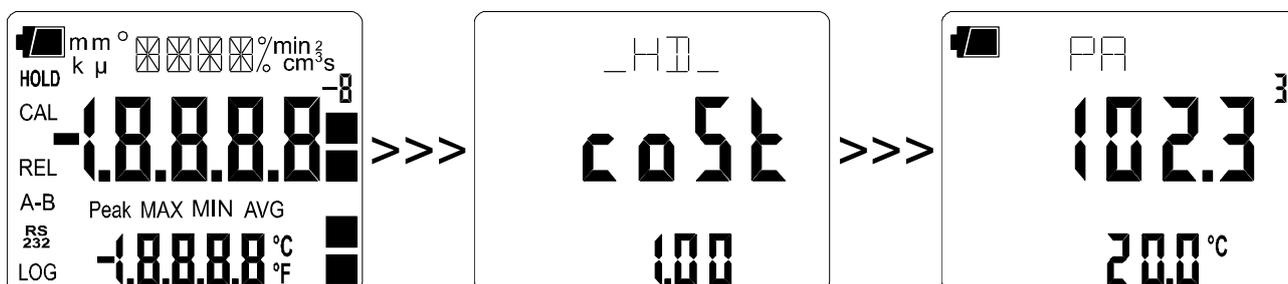
Si en la entrada no hay ninguna sonda termopar conectada, la temperatura de compensación visualizada en la línea secundaria, es la manual. El valor de default es 25°C.
