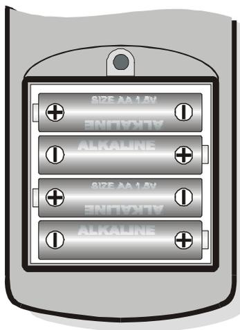
**Después del cambio de baterías, se tienen que configurar de nuevo la fecha, la hora, el baud rate, el tipo de sonda, el intervalo de impresión y los parámetros de logging: para simplificar la operación, cuando se introducen nuevas baterías el instrumento se enciende automáticamente y solicita a continuación todos estos parámetros.** Para pasar de un parámetro al sucesivo pulse la tecla ENTER; para volver en medida, pulse MENU.
