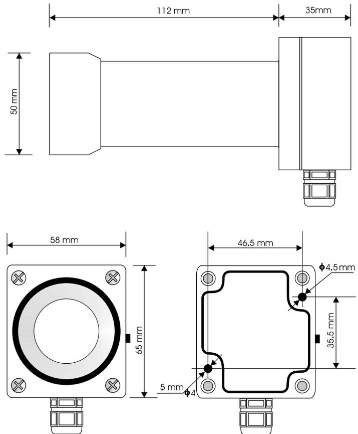
Figura 1. Dimensiones de la sonda HD2021T7
